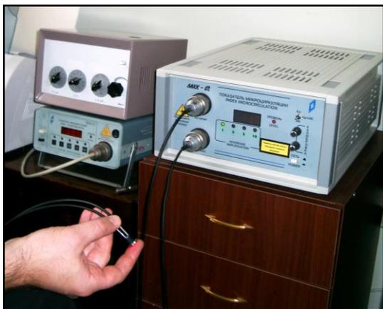
Рис. 2.2.4. Прибор ЛАКК-02 с компьютерным анализом кровотока и прилагаемым стандартным зондом.
