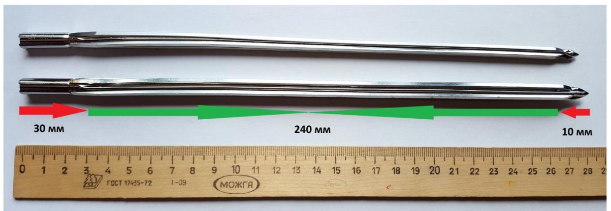
Рис 11. Гвоздь с пластической деформацией в сжатом и рабочем состояниях на фоне измерительной линейки с выделенными частями.
