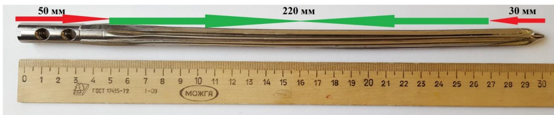
Рис 14. Гвоздь с пластической деформацией, с дополнительным блокированием винтами в проксимальной части, в сжатом состоянии на фоне измерительной линейки с выделенными частями.
