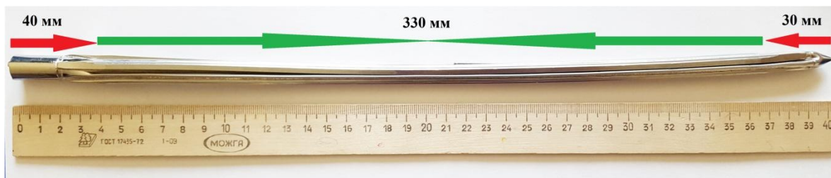
Рис 13. Гвоздь с пластической деформацией в сжатом состоянии на фоне измерительной линейки с выделенными частями.
